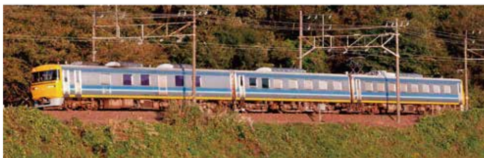
◀ キヤ 95 系軌道・電気総合 試験車 通称：ドクター東海
