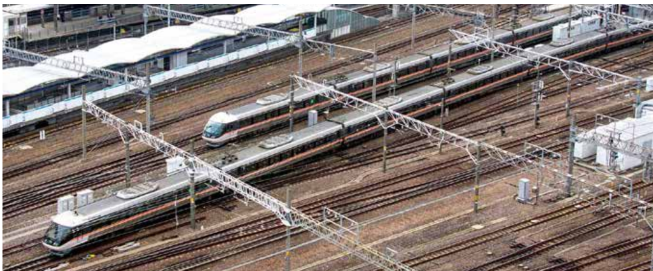
▲ほぼ毎時 00 分に発車する特急「しなの」は、383 系振り子式電車を使用
